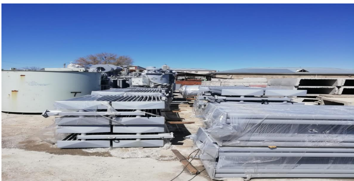
Радиаторы силового трансформатора 35/10 кВ тмн 6300 и 4000 кВА
