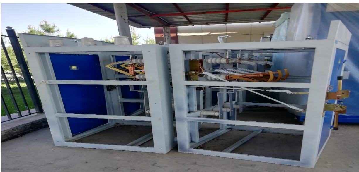
Ячейка КСО-306 С ВНА -10 Кв вводная
